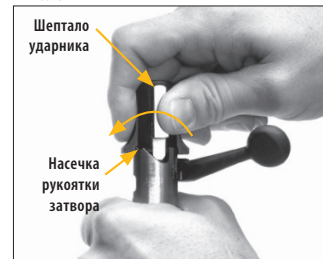
Поверните заднюю часть затвора по часовой стрелке до совпадения шептала ударника и насечки на рукоятке затвора.
