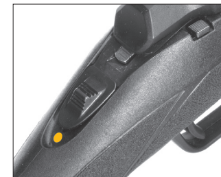
Предохранитель в боевом положении.
