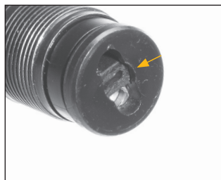
Treskottsadaptern på plats i magasinsröret.
