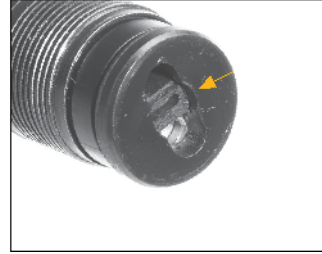
Şarjör tüpüne sabitlenmiş üç saçmalı adaptör
