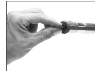
Rimozione del riduttore a tre colpi.
