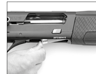
Вставьте патрон в нижнюю часть ствольной коробки и полностью задвиньте его в переднюю часть магазина.
