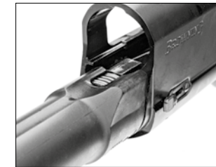
Выверните толкатель с пазом ствольной коробки
