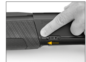
Потяните отсекаль вперед, чтобы разблокировать магазин
